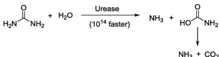
Figura 1. Representação da hidrólise da ureia catalisada pela urease. Fonte: Rego et al. (2018).
